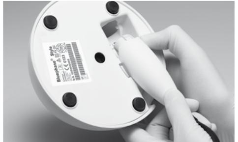
Verbindungsstecker geradlinig in das Handstück einschieben bis er hör- und fühlbar einrastet.
