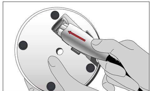
Netz Kabel an das Versorgungsnetz anschliessen und mit dem Netzgerät verbinden. Die Power Anzeige auf dem Netzgerät leuchtet grün auf, und der Leuchtring auf der Ladestation blinkt kurz auf.
