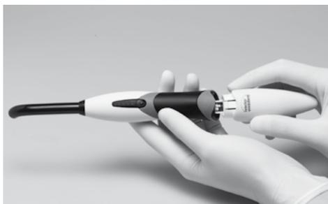
Inserire il manipolo nell'alloggiamento della base di ricarica senza esercitare forza. Se si utilizza un involucro di plastica (guaine monouso) per la protezione igienica, è necessario rimuoverlo prima di caricare la batteria. Utilizzare possibilmente l'apparecchio con batteria completamente carica per prolungarne la durata. Si consiglia pertanto di riporre il manipolo nella base di ricarica dopo ogni paziente. Quando la batteria è completamente scarica, il tempo di ricarica è di ca. 2 ore.
