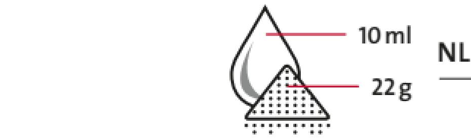
Het doseersysteem garandeert een ideale mengverhouding en een zo laag mogelijke polymerisatiekrimp van het AESTHETIC RED. De schaalverdeling op de polymeercilinder is ingedeeld in grammen. De schaalverdeling op de monomeercilinder is ingedeeld in milliliters.
