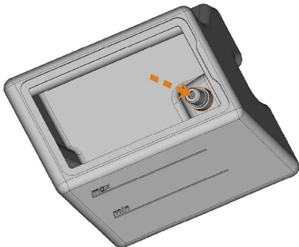
ABB. 99 KUPPLUNG AUS DEM BEHÄLTER DRÜCKEN
