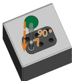
FIG. 44 INSERTAR HERRAMIENTAS EN LAS POSICIONES DE HERRAMIENTAS
