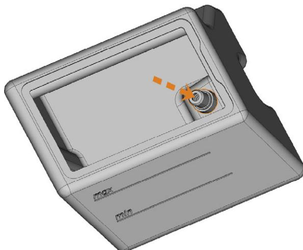
FIG. 99 EXTRAIRE LE COUPLAGE HORS DU RÉSERVOIR
