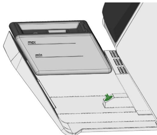
ABB. 38 DIE KUPPLUNG IM BEHÄLTER UND DEREN GEGENPART (GRÜN EINGEFÄRBT)
