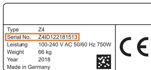
Abb. 8 SERIENNUMMER AUF DEM TYPENSCHILD (ORANGE MARKIERT)
