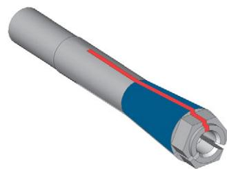
FIG. 77 INGRASSARE LA PINZA DI SERRAGGIO; LA SUPERFICIE SU CUI APPLICARE IL GRASSO È CONTRASSEGNATA IN BLU; L'ALLOGGIAMENTO IN CUI NON DEVE INFILTRARSI IL GRASSO È CONTRASSEGNATO IN ROSSO
