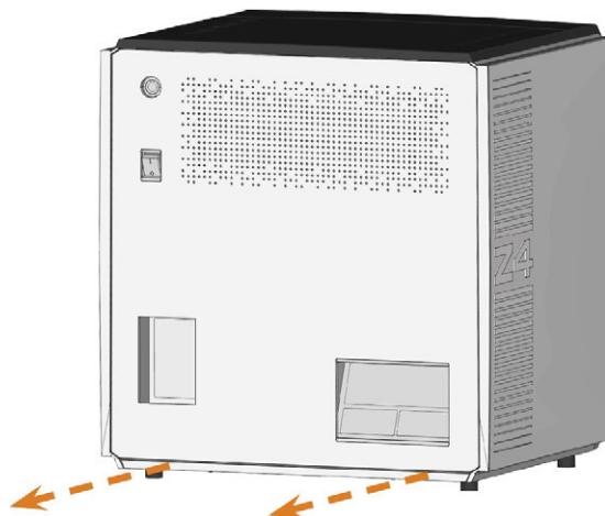
FIG. 61 RIMOZIONE DEL COPERCHIO DEL PANNELLO POSTERIORE
