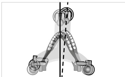
Si le verrouillage central (4.1) est débloqué, le mouvement latéral peut être effectué selon le schéma.
