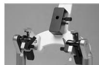
6.2.3 Introducir la placa de orientación en el portainstrumentos, hasta el tope, y fijarla.
