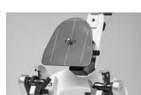
6.2.4 Colocar el articulador con la parte superior (2.3) sobre la mesa de trabajo. Orientar el modelo inferior dentado respecto al punto incisal y controlar la simetría de los posteriores. En caso necesario, inmovilizar el modelo con plastelina.
