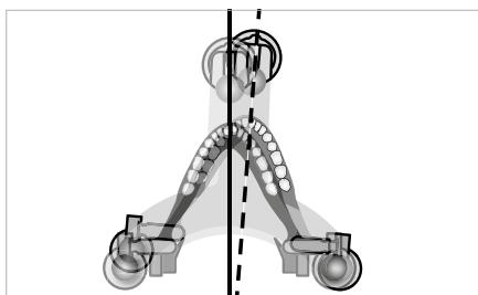
Wird die Zentrikfixierung (4.1) geöffnet, kann die Lateralbewegung gemäss Abbildung durchgeführt werden. Dies wird durch einseitiges Drücken mit dem Daumen auf die entsprechende Gelenkseite erreicht.
