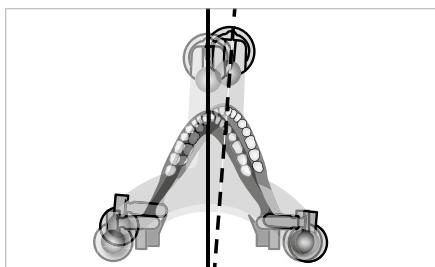
Abriendo la fijación de céntrica (4.1), puede realizarse el movimiento protrusivo según se indica en la figura. Para realizar este movimiento, presionar con los pulgares de forma unilateral sobre el cóndilo del lado correspondiente.
