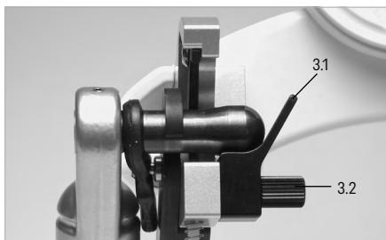
Aflojando el tornillo moleteado (3.2) puede retirarse el elemento de Bennett (3.1) correspondientes.
