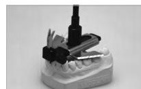
Die Fundamentwaage anschliessend z.B. mit Wachs oder einem Gummiband am Modell fixieren.
