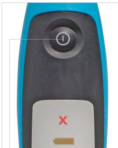
Pulsante Start/Stop per attivare o interrompere il processo di irradiazione
